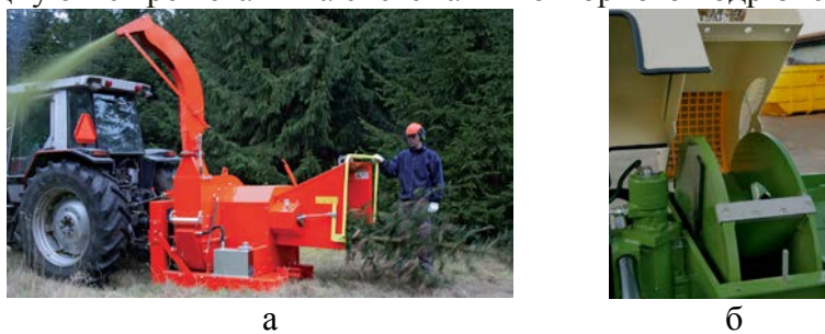
Рис. 5. Деревоподрібнювачі з дисковими різальними пристроями для виробництва каліброваної тріски:
