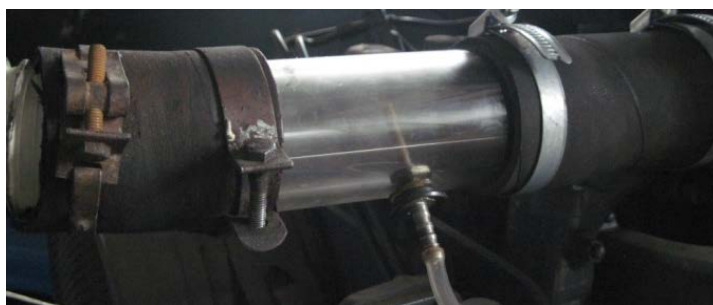
Рис. 3. Подача біоетанолу у повітряний колектор дизельного двигуна Д-21А
