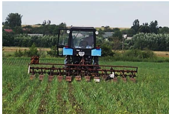
Рис. 3. Обробіток міжрядь свічграсу культиватором КФ-5,4 в агрегаті з трактором МТЗ-82
