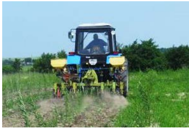
Рис.2. Міжрядний культиватор під час обробітку посадок верби
